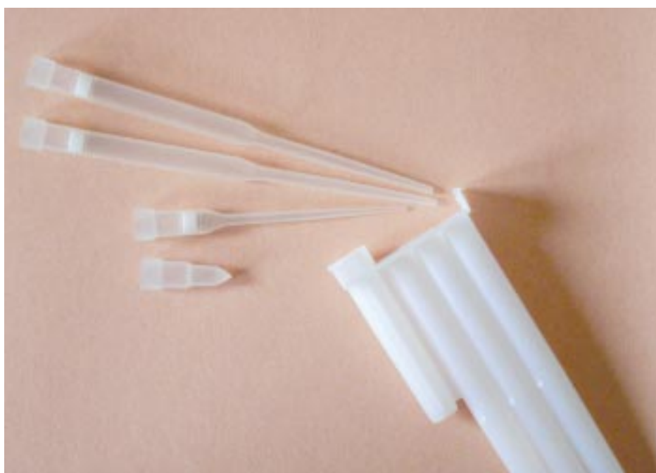
Obr. č. 6: Stojánek, sada špiček pro jednu izolaci včetně děrovacího hrotu pro počáteční protržení hliníkové fólie
