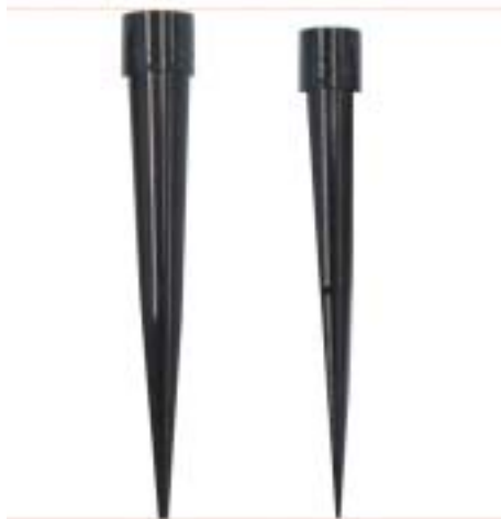
Obr. 4: Názorné srovnání nové jednorázové špičky cobas e 801 (vpravo) se špičkou ostatních imunochemických systémů Roche
