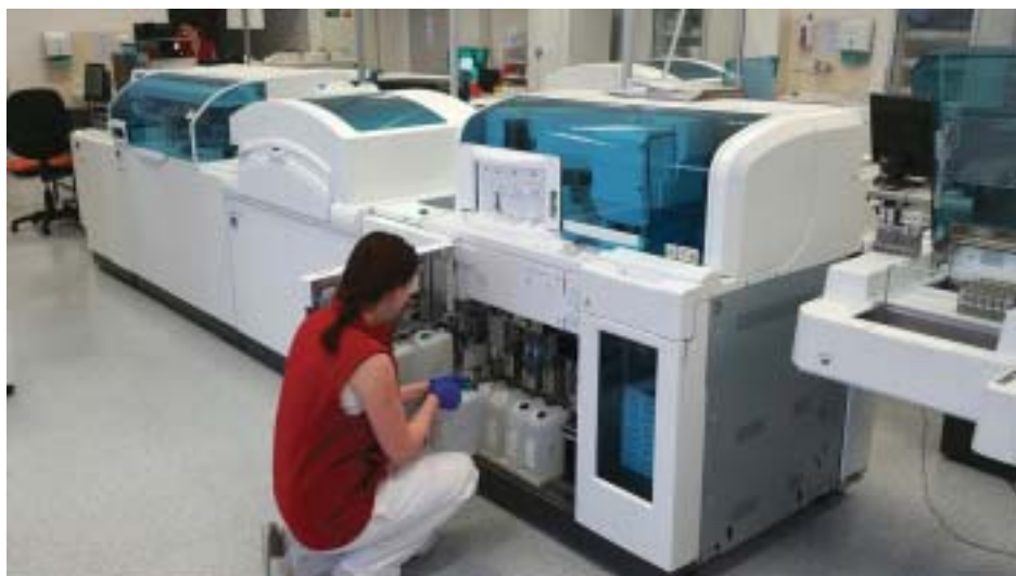
Obr. 5: Výměna spotřebních roztoků za provozu prvního systému cobas e 801 v ČR v centrální laboratoři společnosti SPADIA LAB, a.s., v Ostravě
