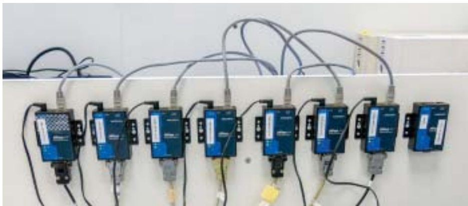
Převodníky Moxa NPort (převádějí komunikaci ze sériového portu do sítě LAN)
